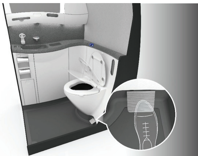
ラバトリーの蓋を足踏み式で開閉することができる。電気式ではないため比較的簡単な改修で設置することが可能だ (提供：ジャムコ)
