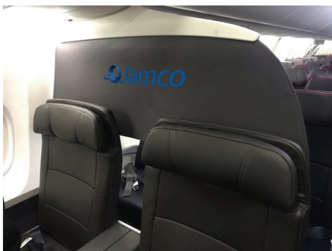
もともとクラス毎を仕切るために開発していたレザータイプのディバイダー(提供：ジャムコ)
