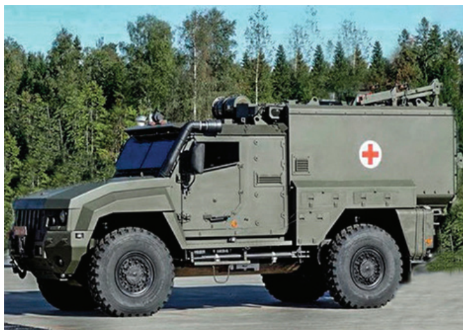
カマズ(KamAZ)製の4輪装甲車「タイフーン4×4」をベースとした装甲救急車「レンズ」(提供:ロシア国防省)
