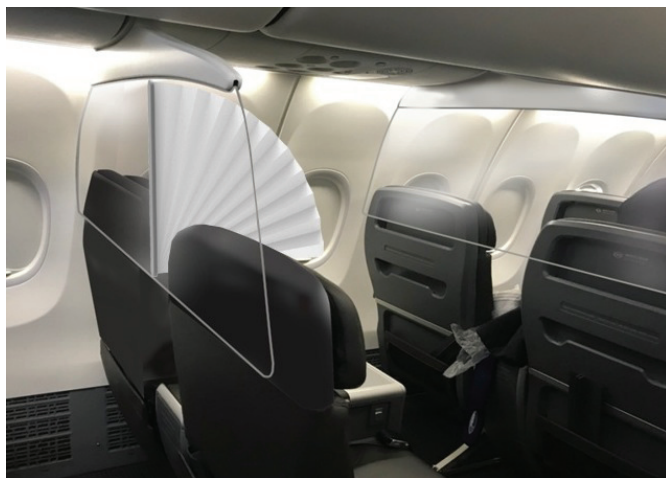
扇型にディバイダーを広げることで旅客が最も気にする隣席との間も仕切ることができる(提供: ジャムコ)
